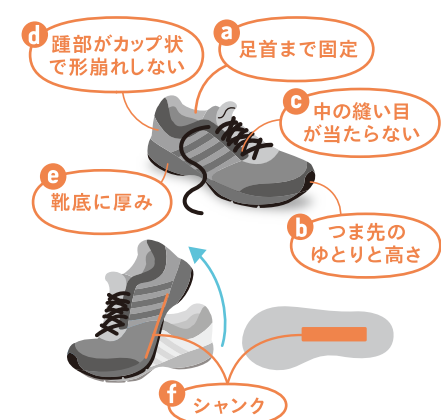
※シャンク：歩行時、地面を蹴り出す時に曲がる指の付け根の位置に合わせ、靴の曲がる位置を決めるもの。指の曲がる位置が合わないシャンクの入っていない靴は、安定していないため疲れやすい。
